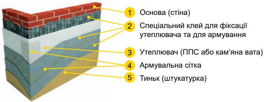
Рис. 7.5. Технологія мокрого фасаду
